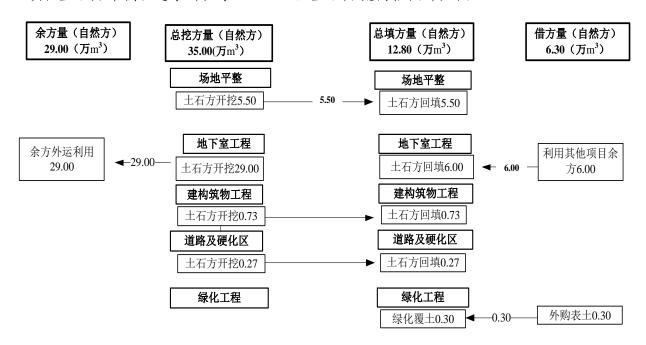
图 2.4-1 项目土石方流向图(单位: 万m³)
