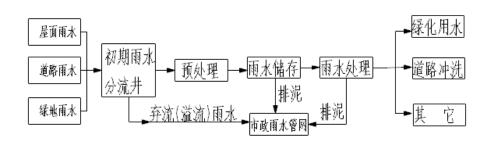
雨水收集工艺流程
